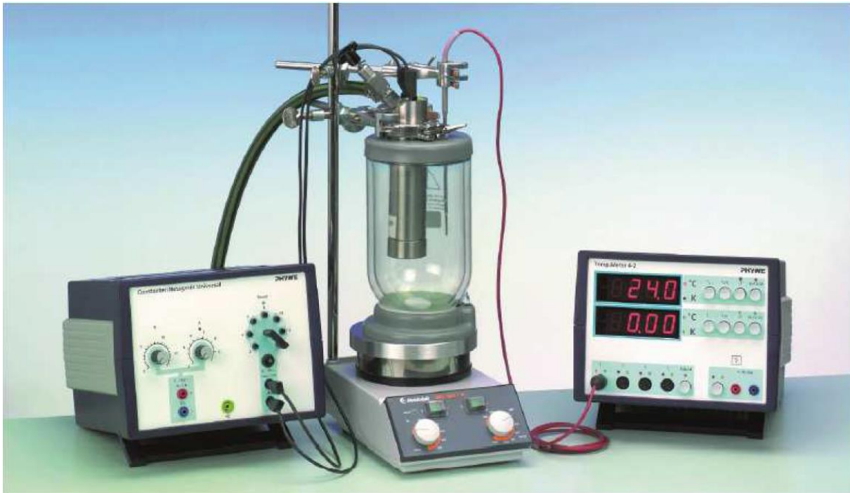
Abb. 1: Foto des verwendeten Kalorimeters
