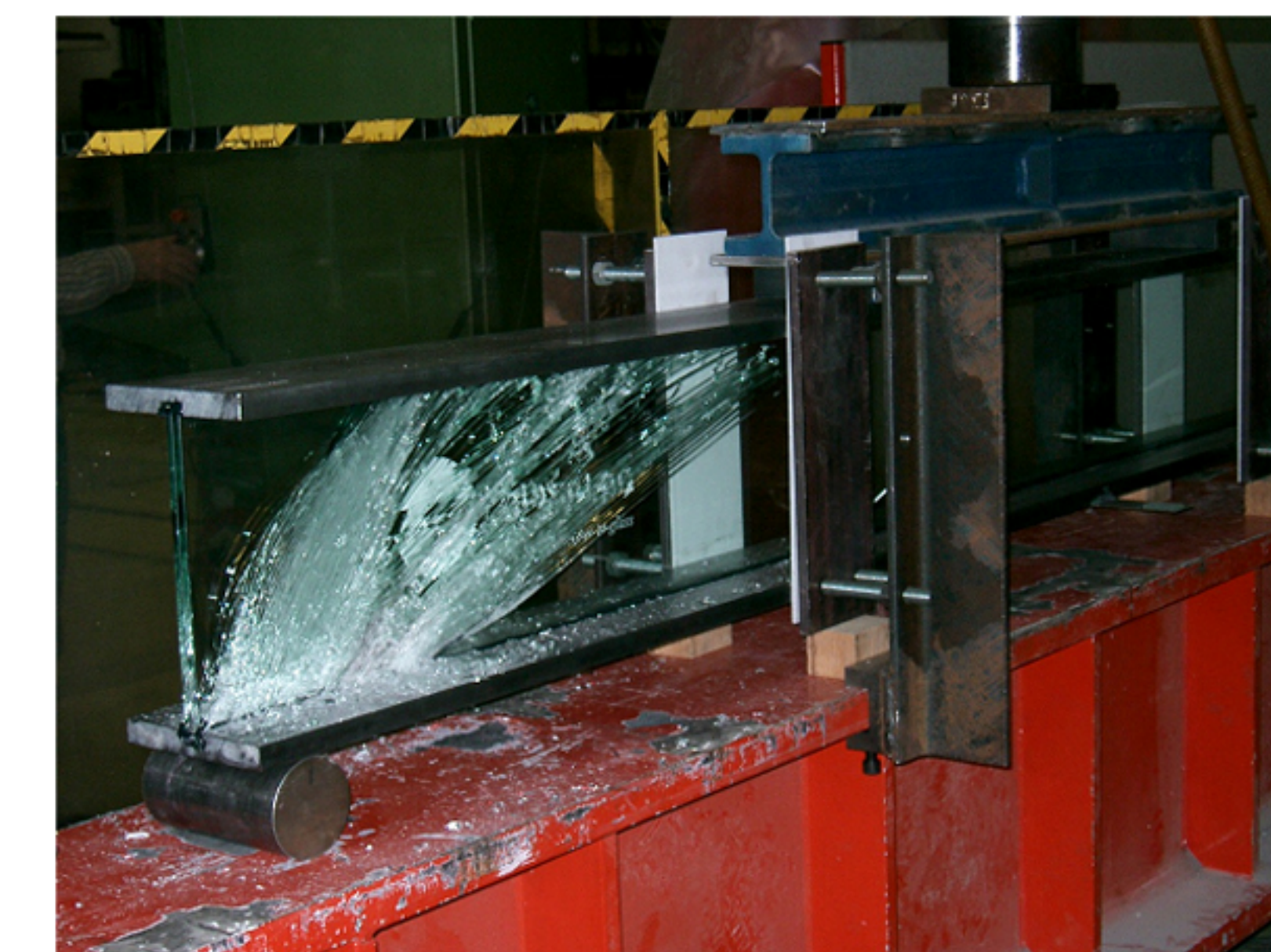
Vierpunktbiegeversuch Hybridträger L=2,50m
