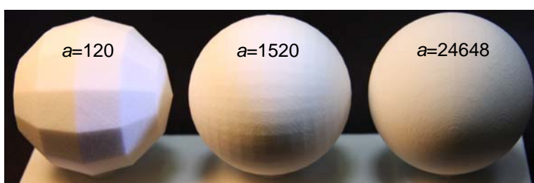
Abbildung 15: Einfluss der Dreiecksanzahl a auf die Bauteilqualität generativ gefertigter Bauteile (Lasersintern)
