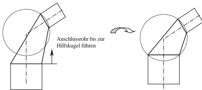
Abbildung 5. Auslaufkonen am Behälter.
