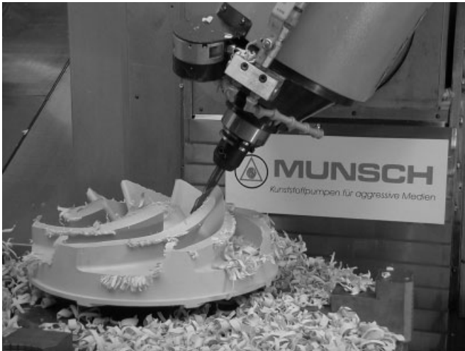
Abbildung 14. Spanende Fertigung eines Kunststofflaufrades [24].
