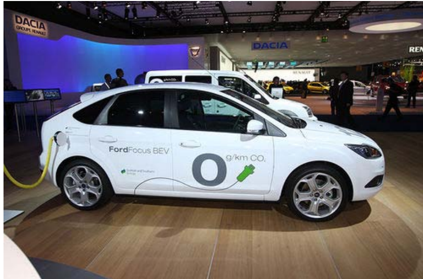
Angetrieben wird er von einem Elektromotor mit 100 kW Leistung.
