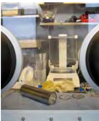
40 Ah Batterien für den elektro-mobilen Bereich werden unter Luft-ausschluss in Gloveboxen geöffnet und beprobt.
