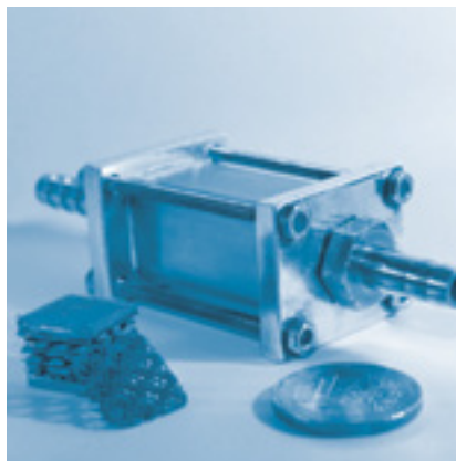
Prototyp eines Katalysatorgehäuses mit Katalysatormaterial
