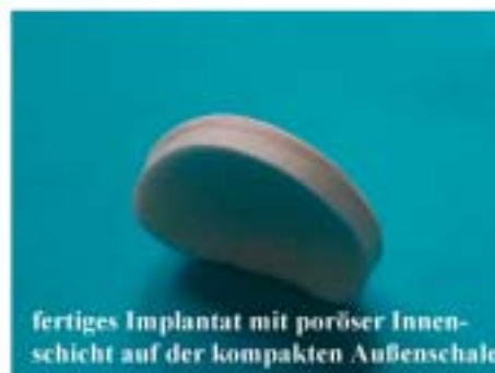
Abbildung 7: Fertigung individueller Implantate zur Rekonstruktion von Schädeldefekten aus einem physiologisch abbaubaren Polymer-Calciumphosphat-Verbundmaterial.
