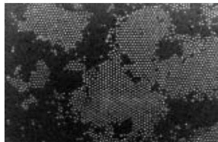
Abbildung 9: Elektronenmikroskopische Aufnahme von magnetischen Teilchen mit einem Durchmesser von 6 Nanometern in einer Schicht, die in ihrer chemischen Zusammensetzung einer Zellmembran gleicht. Die Teilchen sind innerhalb der Schicht beweglich und können im Magnetfeld regelmäßige Strukturen bilden.
