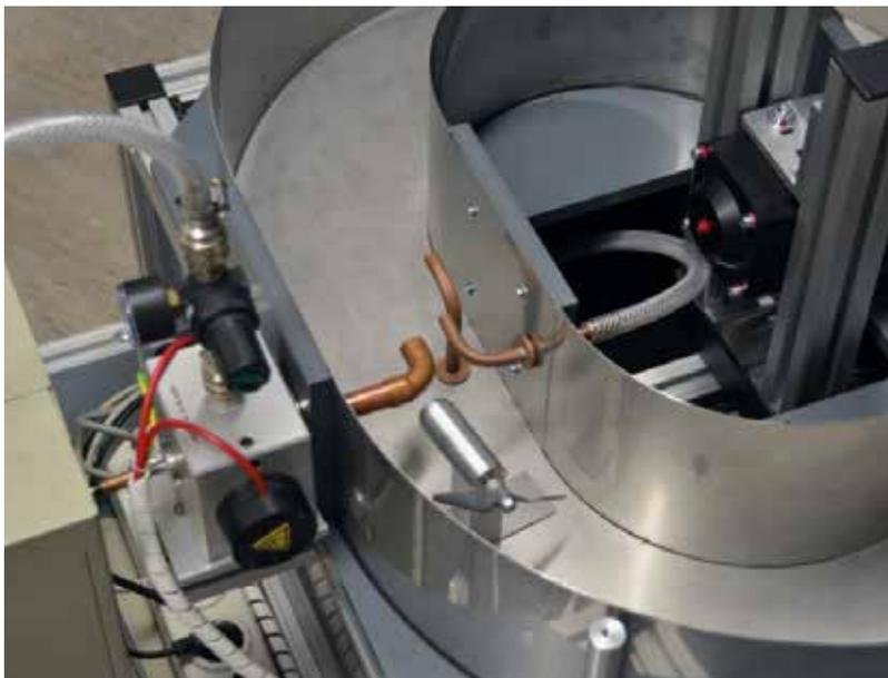
Experimenteller Aufbau eines Stör-Aerosol-Generators mit Messkanal
