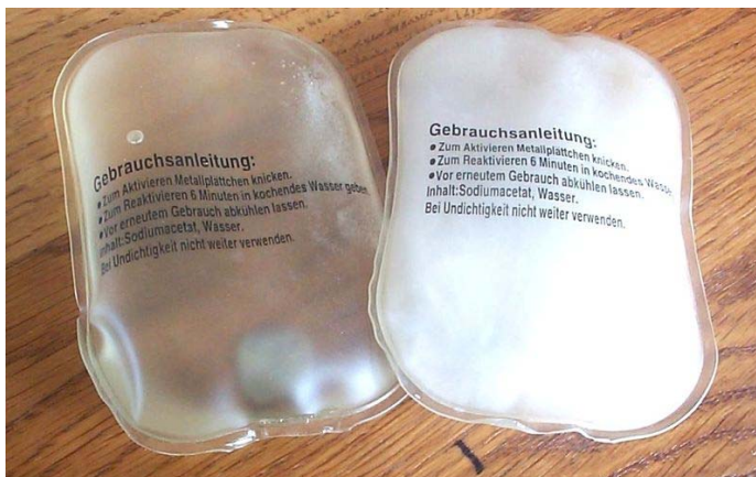
Abb.: Latentwärmespeicher als Handwärmer
