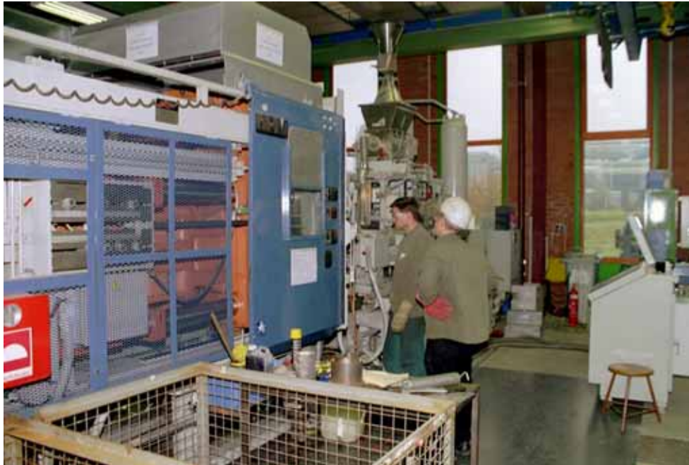
Thixomolder: Legierungserprobung von Mg-Granulaten
