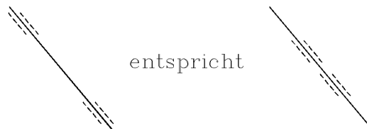
Bild 2.1: Der Fuzzy- c -Varieties-Algorithmus ( r = 1 ) bestraft die beiden dargestellten Datenhäufungen nahe der Linie, aber mit unterschiedlicher Streckung in Linienerichtung, gleich.
