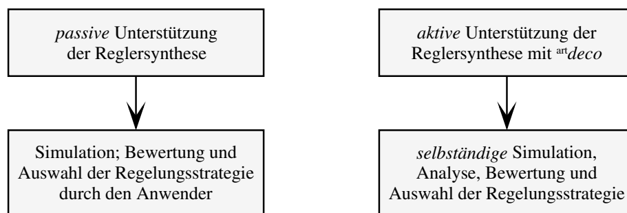
Bild 4.2: Aktive versus passive Entwurfsunterstützung bei der Reglerauslegung
