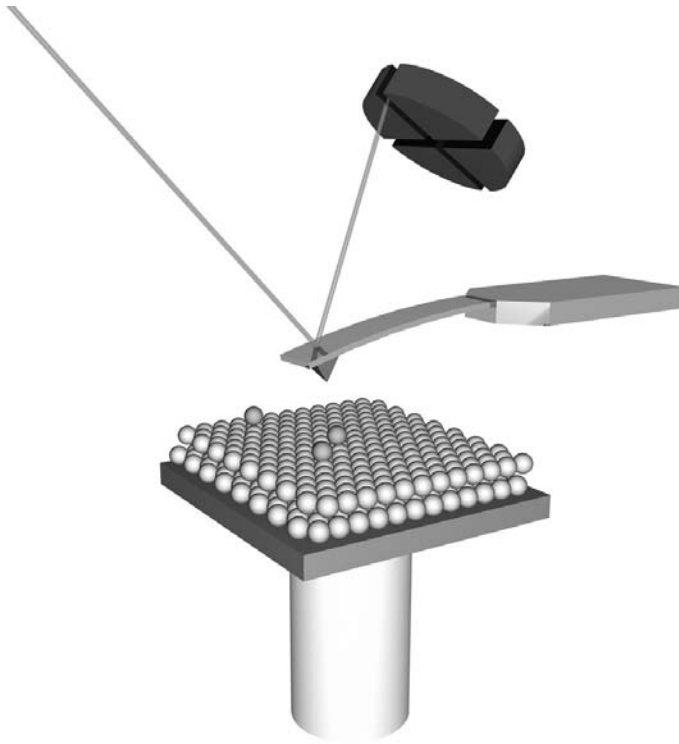
(4) Prinzip eines Rasterkraftmikroskops. Die Oberfläche wird mit einer Nadel zeilenweise abgetastet. Die Bewegung der Nadel wird mit Hilfe eines reflektierten Lichtstrahls aufgezeichnet und liefert ein direktes Abbild der Oberfläche.
