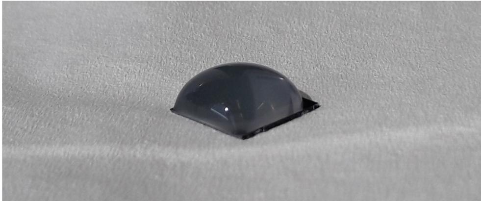
**Abbildung 5:** Verwendete Methodik zur Herstellung der verwendbaren Proben. Es befinden sich  $300\ \mu\text{l}$   $\text{Gd}_2\text{O}_3$ -Reinstwasser-Lösung auf einem Si-Substrat. Die Lösung trocknet an Luft unter Laborbedingungen, die Nanopartikel setzen sich flächendeckend auf dem Substrat ab.
