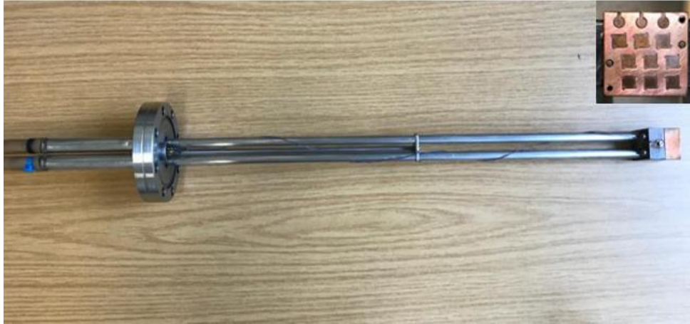
Abbildung 3.3: Seitenansicht des Probenhalters. Oben rechts ist das Foto des Kupferblocks mit den Mulden zur Substratplatzierung eingeblenet.
