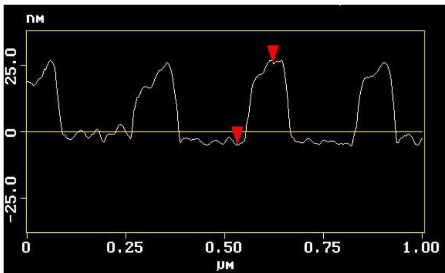
Abbildung 25: AFM-Profil der Gold-Dots. Die roten Pfeile haben eine Höhendifferenz von 30,6 nm.
