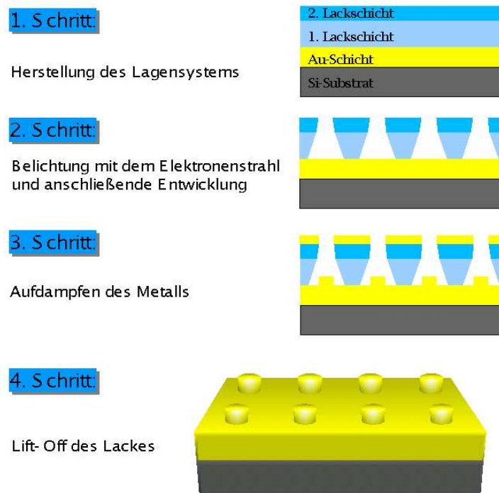
Abbildung 35: Herstellung der Dot-Proben mit Elektronenstrahlolithographie
