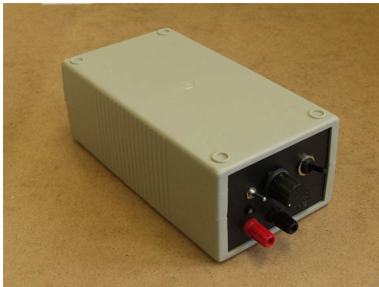
Abbildung 46: Elektronik zum dc-Ätzen der W-Spitzen: Oben rechts: Einschaltknopf; oben Mitte: Spannungsregelung; oben links: Starttaste; Mitte links: Kontrolldiode; unten links: dc-Ausgang für den Ätzprozess
