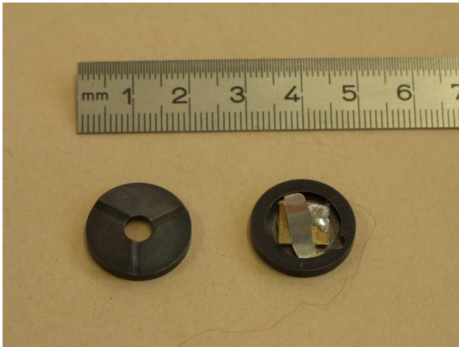
Abbildung 14: Probenteller des STM, links: Unterseite mit Tripelhelix, rechts: Oberseite; hier ist eine Probe, auf einem Messingblech klebend, in den Probenteller eingelegt und mit einer Blattfeder fixiert. Die Probe wird durch die Bohrung im Probenteller von unten mit der STM-Spitze abgerastert. Auf dem Messingblech ist ein Kupferlackdraht aufgelötet, mit dem die Probe elektrisch kontaktiert wird (siehe Kapitel 3.5.2).
