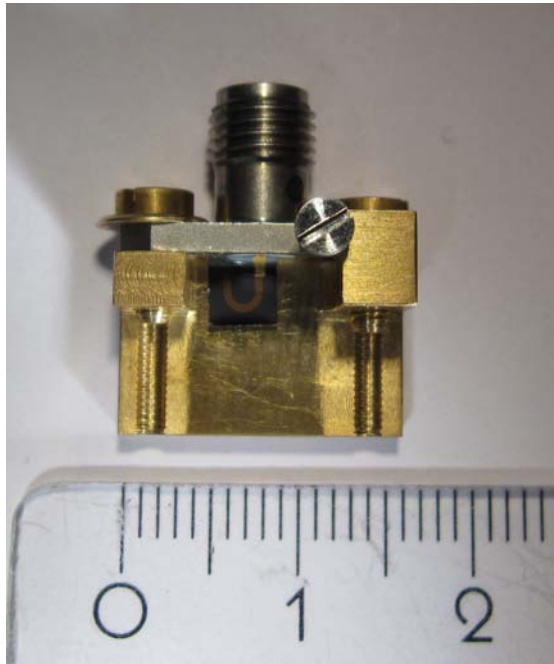
Abbildung 3.19: Probenhalter mit Massstab in cm. An der Oberseite befindet sich die Cassisbuchse mit dem Anschluss für das Koaxialkabel. Durch die Stellschraube, rechts, wird der Stiftkontakt auf den Mikroresonator, der sich mittig auf den Probenhalter befindet, aber bündig an die Chassisbuchse anliegt, heruntergedrückt.
