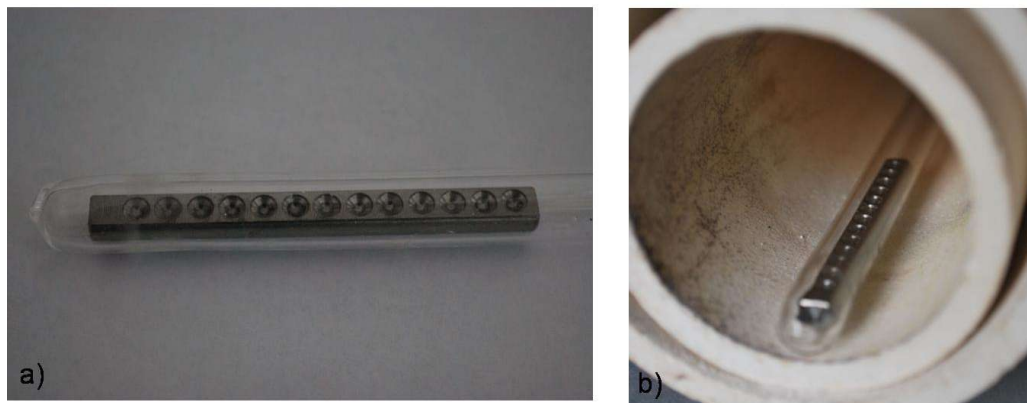
Abbildung 49: a) Der Tantalprobenhalter zum Ausheilen einzelner Partikel. Eingeschlossen in einer Quarzröhre um Argonatmosphäre bei Temperaturen von 50 bis 800°C an zu bieten. b) Der Tantalprobenhalter an der Öffnung des Ofens
