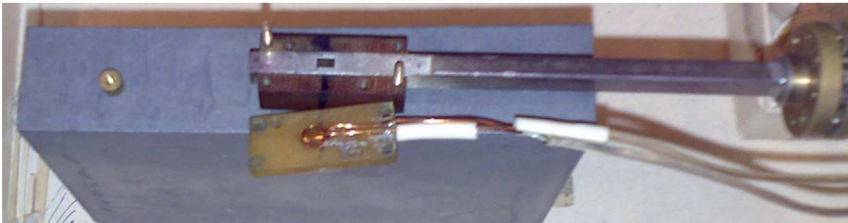
Abbildung 2.1: ‘Short-cut waveguide’ – kurzgeschlossener Mikrowellenhohlleiter für 49 GHz wird in der FMR-Anlage an der Akademie der Wissenschaften in Prag benutzt. Die Probe wird mit der Filmseite an der Hohlleiteröffnung angebracht und mit dem Deckel, in den die Modulationsspule eingearbeitet ist, befestigt.
