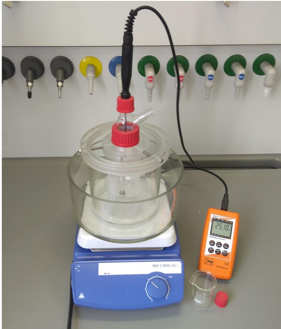
Abb. 2: Apparatur zur Bestimmung von Gefrierpunktserniedrigungen.
