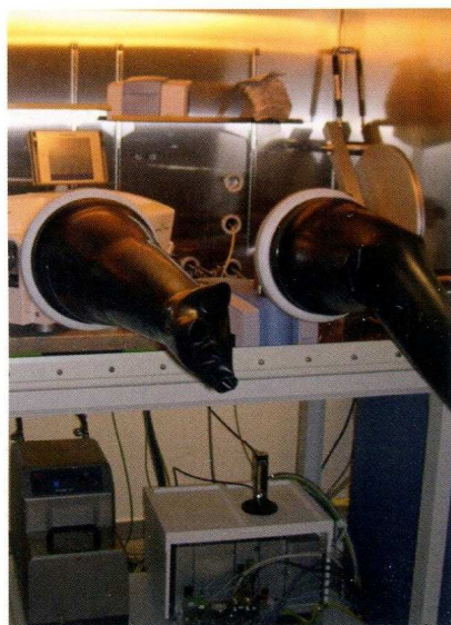
Abbildung 1: TGA/DSC 1 in der Glovebox; die Messzelle (innerhalb der Glovebox) und Steuerung- und Kühleinheit (außerhalb der Glovebox) sind räumlich getrennt.
