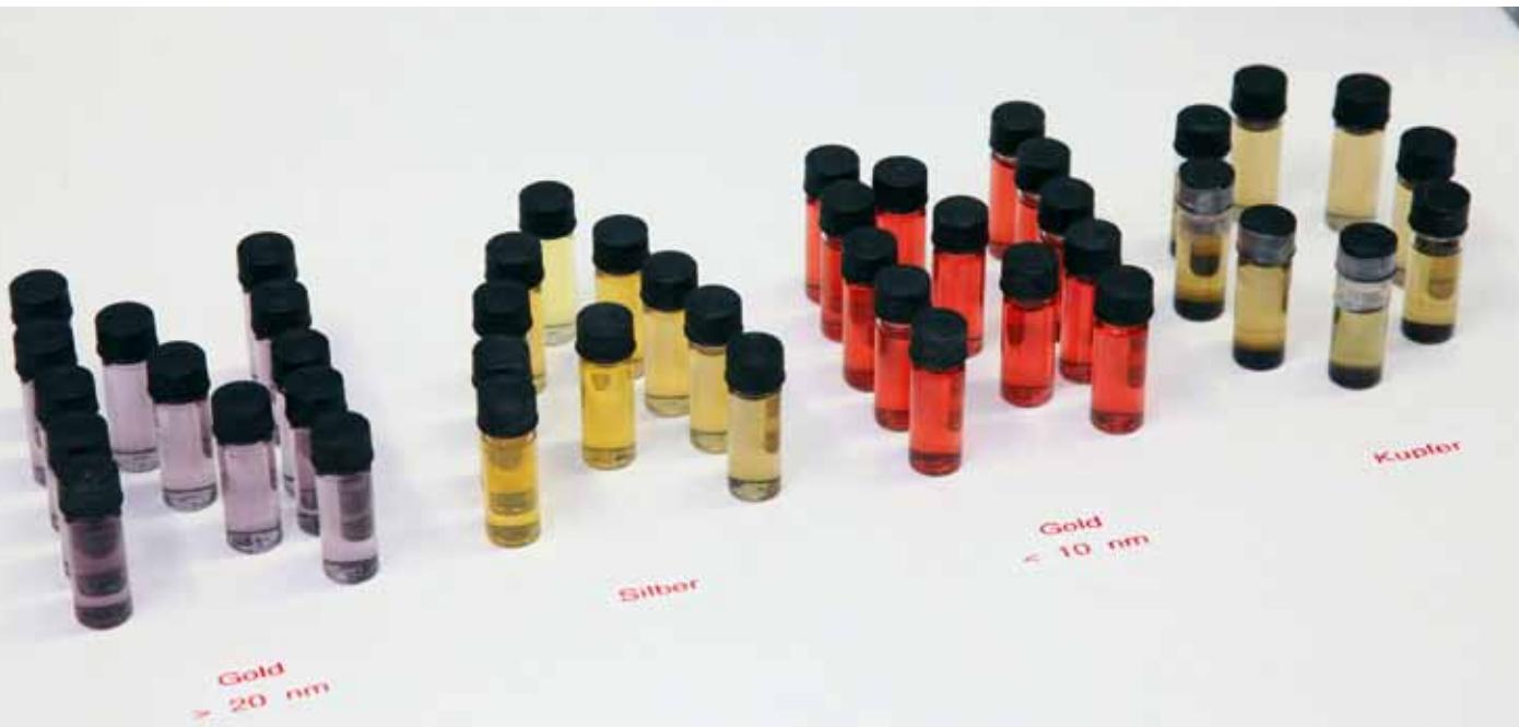
Verschiedene Kolloide mit lasergenerierten Nanopartikeln aus Edelmetallen.
