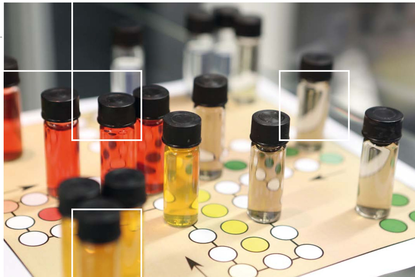
Verschiedene Kolloide mit lasergenerierten Nanopartikeln aus Edelmetallen Different colloids with laser-generated nanoparticles of precious metals
