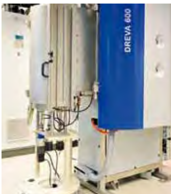
Industrielle Beschichtungsanlage mit integriertem Modul zur Abscheidung von ta-C-Schichten
