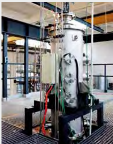
Heißwandreaktor zur Synthese von Silizium-Nanopartikeln
