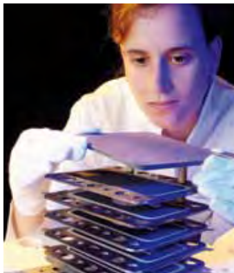
Miteinander gekoppelte Brennstoffzellen für mehr Leistung: die Hochtemperatur-Brennstoffzelle SOFC
