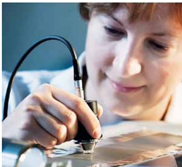
Dickenmessung einer Elektrodenschicht am Institut für Materialforschung III, KIT
