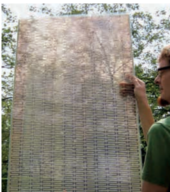
Am Fraunhofer ISE gefertigter großflächiger Prototyp eines Farbstoffsolarmodules
