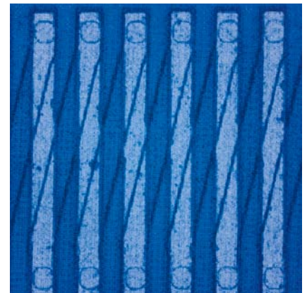
Thermoelemente auf einem Silizium-Chip
