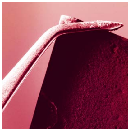
Metallfolie mit CNT-Beschichtung
