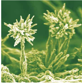
Titel: „Nano-Bäume“, eine dreidimensionale Nanostruktur, entstanden durch kontrolliertes Wachstum von Siliziumcarbid-Nanodrähten auf Galliumpartikeln als Keim.
