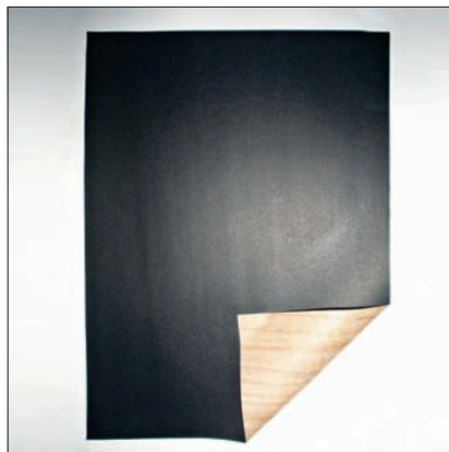
Mit CNTs beschichtetes „Braun Heat Paper“
