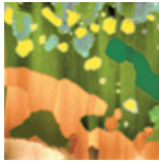
Rastertunnelmikroskop-Aufnahme einer mit Bismut und PTCDA bedampften Silber(111)-Oberfläche © CENIDE, AG Möller, Maren Cottin
