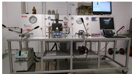
Abb. 4: Anlage zur Simulation von bis zu 10 km Tiefe
