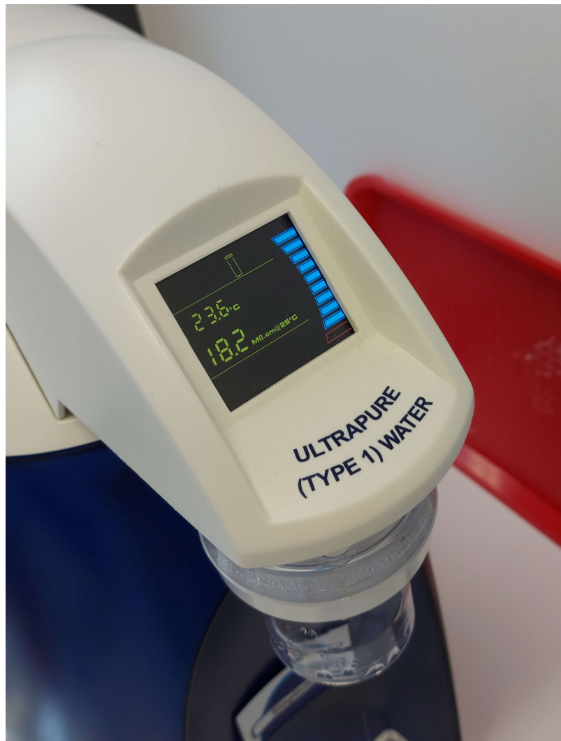
Abbildung 3: Bild der genutzten Wasserfilteranlage mit dem abgelesenen Wert von 18.2 \text{M}\Omega\cdot\text{cm} zur Zeit der Messung.
