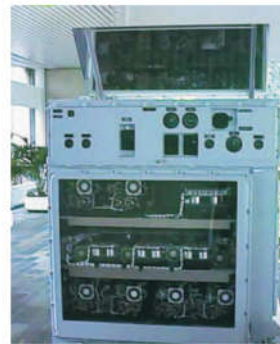
Elektromechanisch vuurleidings toestel ("rekenaar") Fabrikaat N.V. Hollandse Signaalapparaten, 1952-1960
