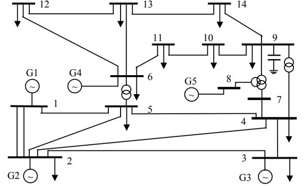
Fig. 8. IEEE 14-bus test system
