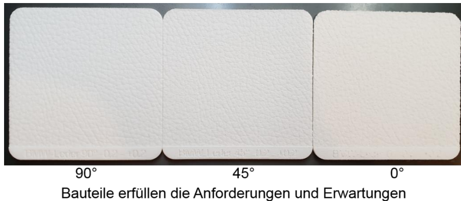
Abbildung 101: Übersicht über die erreichbaren Oberflächenqualitäten
