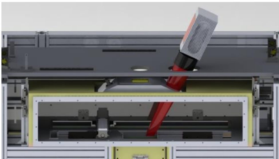
Abbildung 59: Einbaubedingungen der Thermografiekamera Image IR 5300
