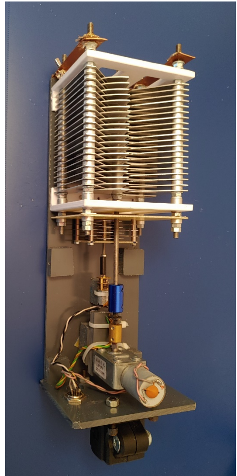
Bild 9 Der Drehkondensator (oben) der MLA mit Antriebs-Motoren (unten)
