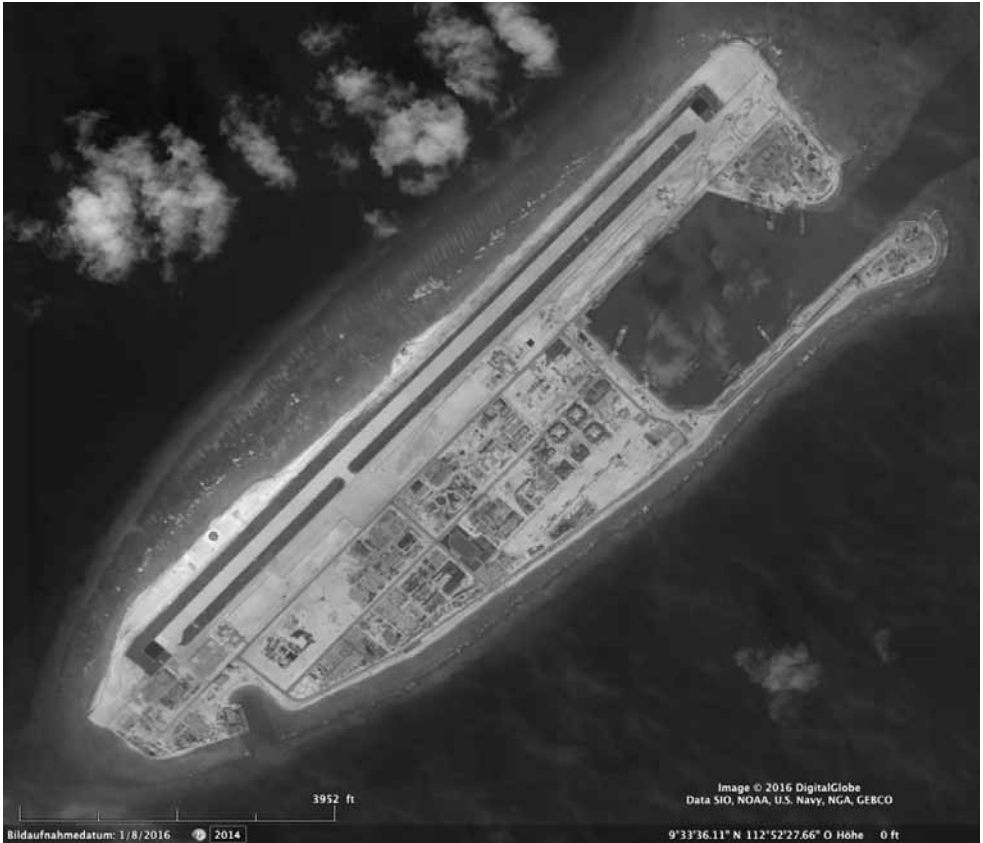
Fiery Cross Riff in der Spratly-Gruppe. Umfangreiche Aufschüttungen haben den Bau des „südlichsten Flughafens Chinas“ ermöglicht. Quelle: Google Earth/Digital Globe
