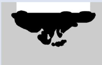
Simulierte Dampfstruktur unterhalb eines Sonotrodenkopfes
