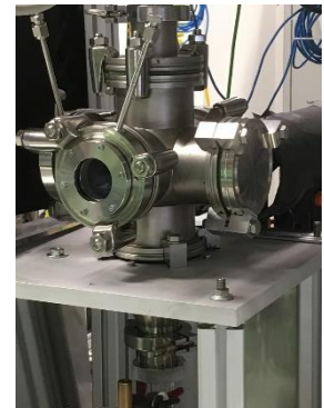
Optisch zugängliche Messzelle im Strömungssystem
