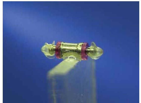
Technik im Dienst der Medizin: Druck-Temperatur-Multisensor in Glasfasertechnik.
