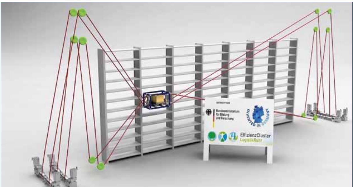
Tauziehen auf hohem Niveau: Entwurf des Regalbediengeräts. Der Prototyp soll noch dieses Jahr folgen.
