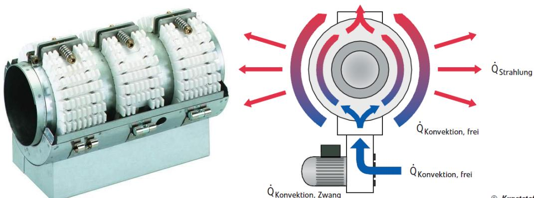
Dazu sollen in dieser Abschlussarbeit die Geometrieparameter des zentralen Luftkühlsystems angepasst werden, so dass mit der zur Verfügung stehenden Leistung des Sauggebläses ein Maximum an Abwärme mit möglichst geringen Verlusten abgeführt werden kann. Dazu sollen besonders die Isolierungen, Leitungsquerschnitte, sowie die Geometrie und das Material der Kühlrippen betrachtet werden.
