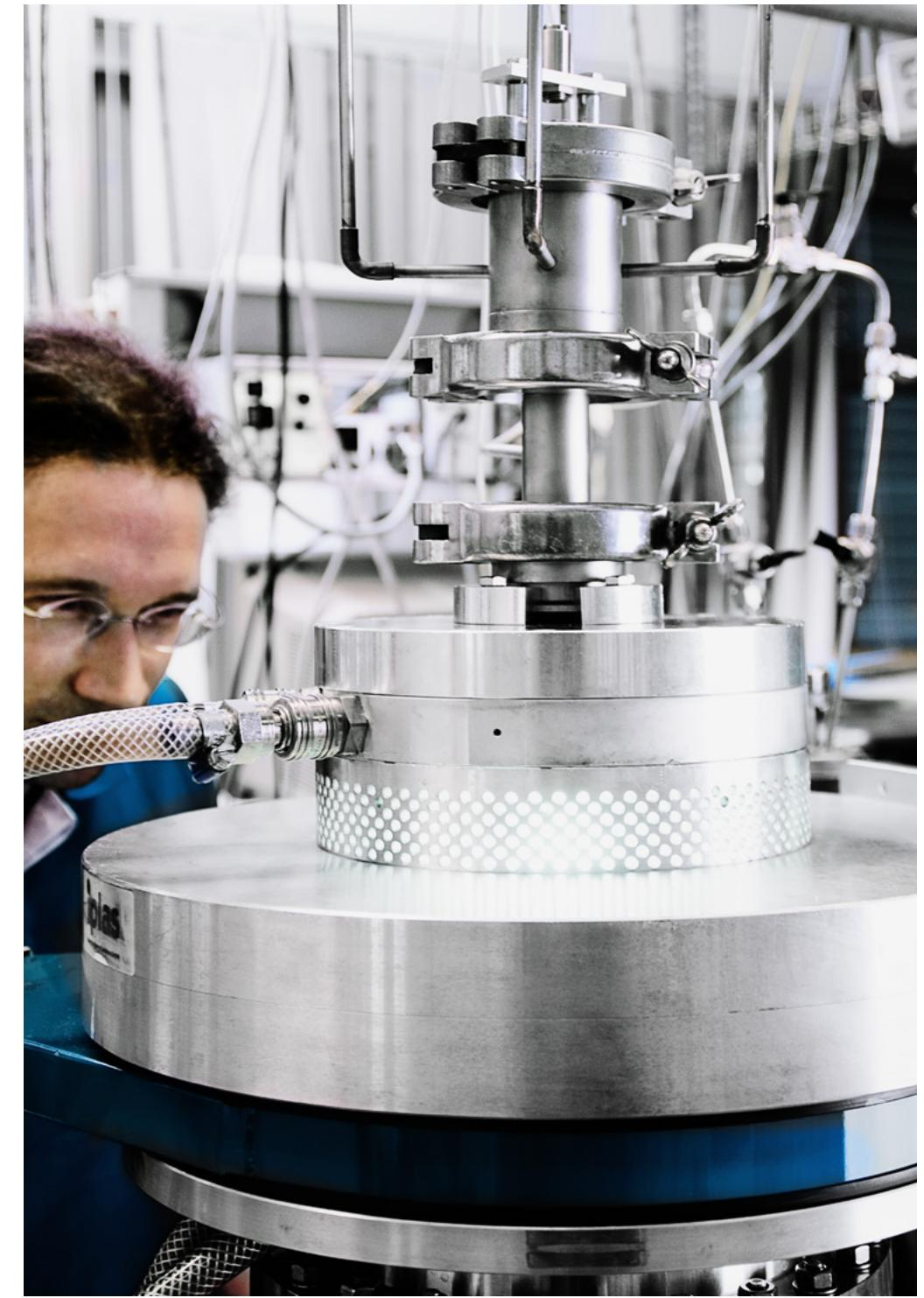
Plasmareaktor zur Synthese von nanostrukturierten Schichten
