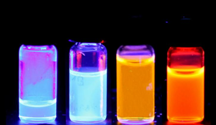
Nanoskalige Leuchtmittel für den Einsatz in großflächigen LEDs
