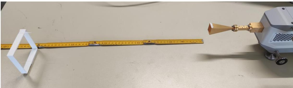
Ein photonischer Kristall-Resonator wird mit einer dielektrischen Antenne integriert, um Krankheitserreger über große Entfernung zu erkennen. Die Antenne für einen großen Antennengewinn und gute Druckbarkeit designt. Die Signalstörung durch Umgebung (clutter) wird durch Techniken der digitalen Signalverarbeitung unterdrückt.
