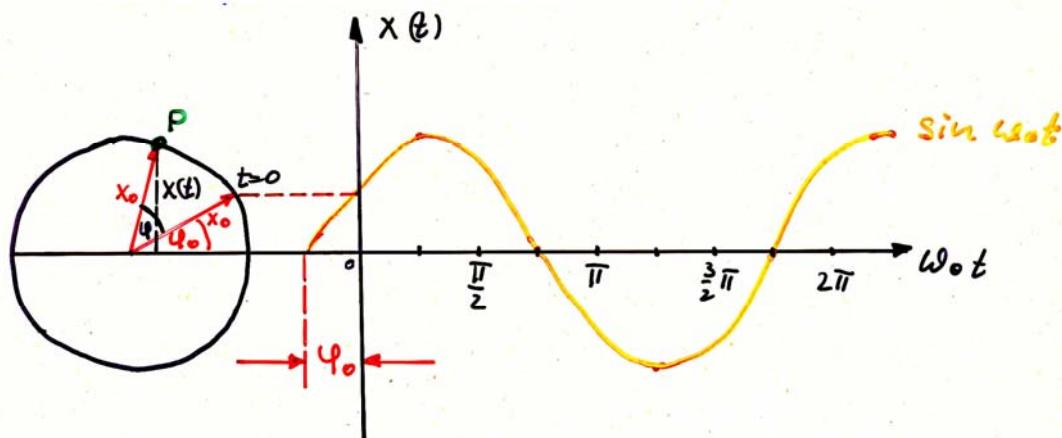
Man sieht, dass der Zeiger mit dem Phasenwinkel  $\varphi_o$  vorauseilt“.
