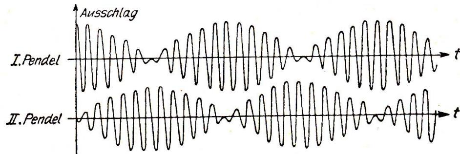
Jedes der beiden Pendel führt eine Schwebung aus.
