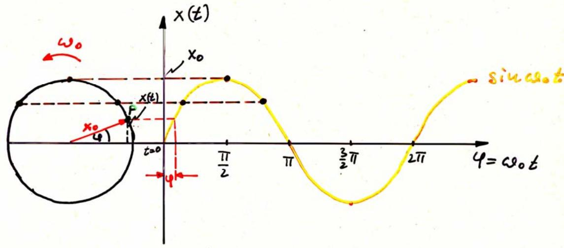
Aufgetragen wird die Projektion des sich drehenden Zeigers der Länge  $x_o$  auf die  $x(t)$ -Achse über dem Winkel  $\varphi = \omega_o t$ . Zur Zeit  $t$  ist der Zeiger gerade im Punkt  $P$  angelangt.
