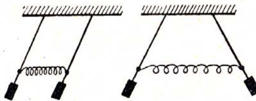
Unter Berücksichtigung der Dämpfung erhalten wir für den Resonanzfall folgendes Bild:
