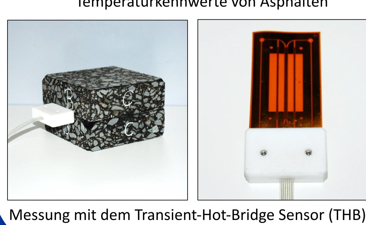
Die Temperaturkennwerte wurden mit der THB Methode an Asphaltprobekörpern bestimmt. Um repräsentative Ergebnisse zu erhalten, wurden an jeder Probekörperserie 120 Messung durchgeführt. Alle untersuchten Stahlwerksschlacken zeigen eine geringere Temperaturleitfähigkeit, als die Asphalte, die mit natürlichen Gesteinskörnungen hergestellt wurden.
