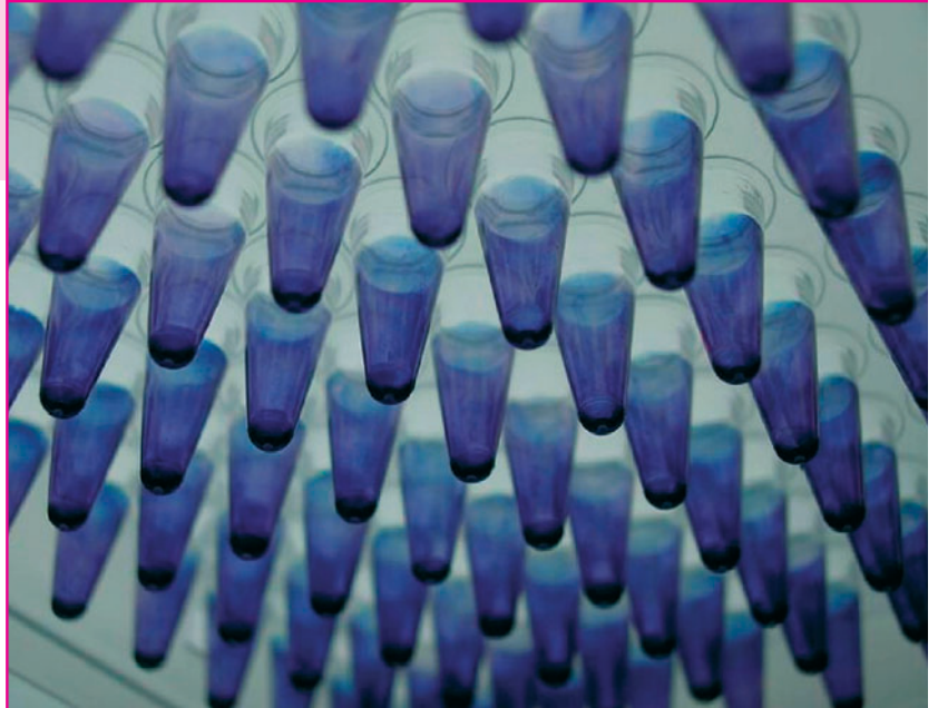
Abbildung 7: Pfropfpolyacrylsäure-funktionalisierte 96-Well Mikrotiterplatte aus Polypropylen: Die Färbung mit einem carboxyl-reaktiven Farbstoff zeigt die hohe und sehr gleichmäßige Bindungskapazität der Oberfläche in jedem Well (ELIPSA GmbH, Berlin).
