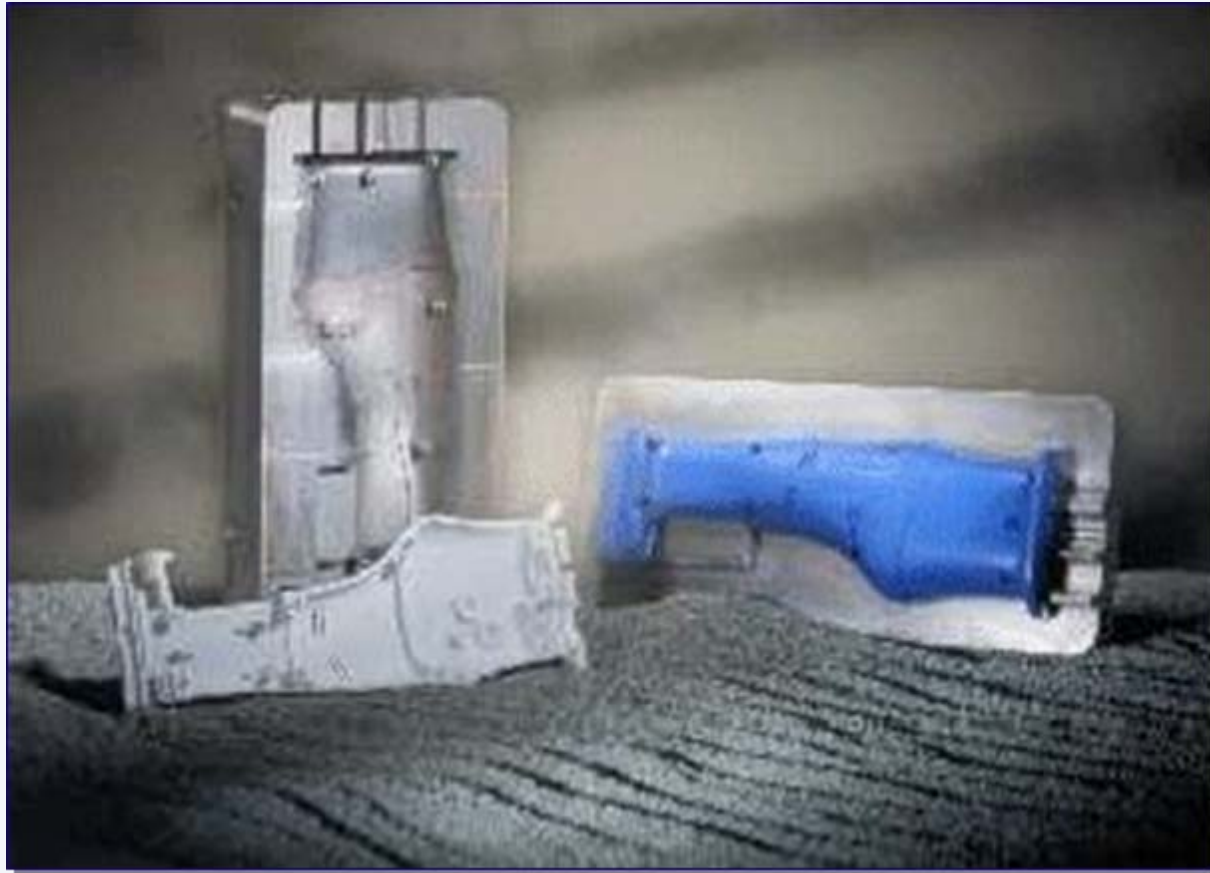
Metallische Werkzeugeinsätze für die Herstellung von Bohrmaschinengehäusen im Kunststoffspritzguß, Abmessungen ca. 152 x 317 x 38 mm 3
