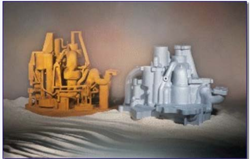
Sandkern und Abguß in Aluminium für Turbinentriebwerk, Fa. Boeing, Abmessungen ca. 430 x 350 x 305 mm 3
