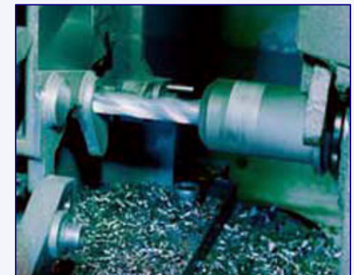
Zerspanprozeß ohne Kühlschmierstoff (Quelle: IWU)
